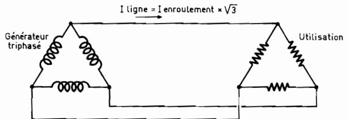
Tension entre phase et neutre :  $5\,000 / 1,732 = 2\,886,83 \text{ V}$ .
